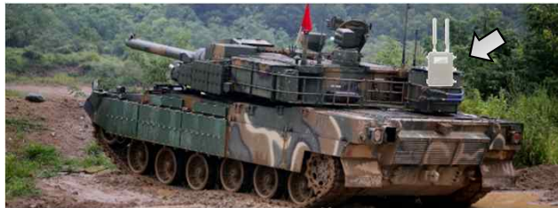
기동훈련장 전차 후방설치(카메라, DVR/NVR영상 전송) 이동체 운용에 필요한 핸드오프기능 지원
