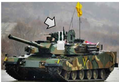
기동훈련장 전차 후방설치(카메라, DVR/NVR영상 전송) 이동체 운용에 필요한 핸드오프기능 지원
