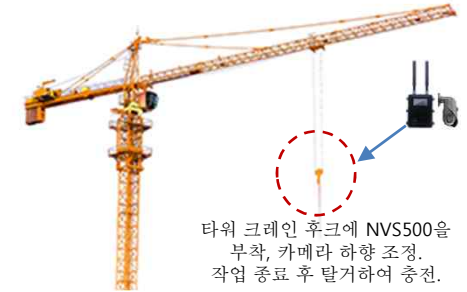
크레인 후크에 NVS500을 부착 카메라 하향 조정. 작업 종료 후 탈거하여 충전.
