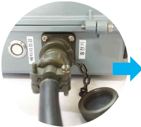
트롤리가 운전실에 도착하면 충전기 방수 캡을 열고 커넥터를 연결합니다. 방전상태에서 100%충전 시 까지 약 6시간 소요됩니다.
