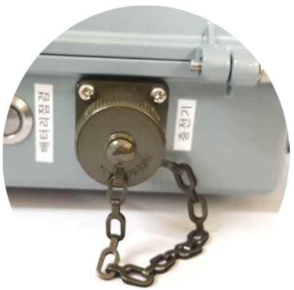
충전기에 녹색LED가 점등되면 만 충전 상태이므로 방수 캡을 닫습니다. 100%충전 시 약 12시간 연속사용 가능합니다.
