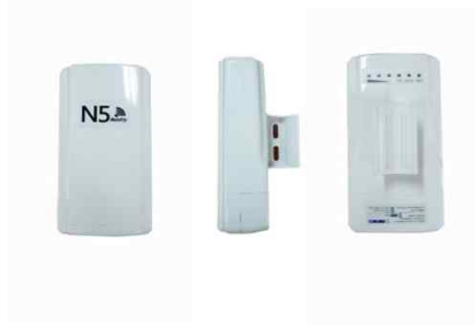
Antenna 2x2 60° 14dBi MIMO
